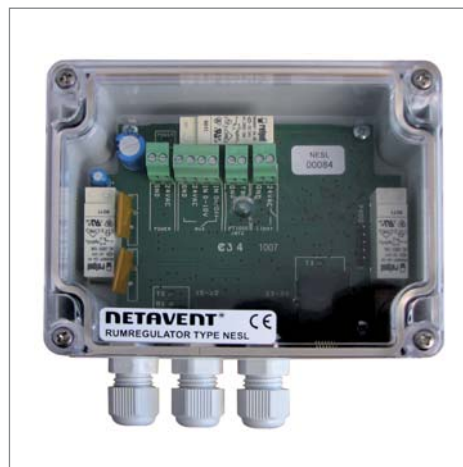
Rumregulatoren er den centrale enhed i systemet.
