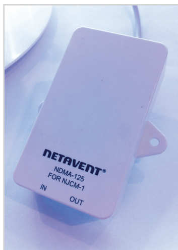
NMBC/EJC-125 inkl. NDMA-125 (tv). NDMA-125 placeres udenpå trykfordelingsboksen (midt og th.).
